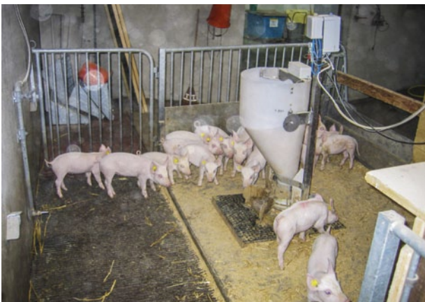
Figure 1 | Automate commercial pour l'alimentation liquide des porcelets, modifié par le fabricant pour l'utilisation de lait. Le lait, stabilisé avec de l'eau oxygénée, est stocké dans un seau fermé, équipé d'un mélangeur. Le lait aspiré par une pompe est mélangé avec l'aliment solide dans l'auge.
