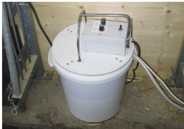
Figure 1 | Automate commercial pour l'alimentation liquide des porcelets, modifié par le fabricant pour l'utilisation de lait. Le lait, stabilisé avec de l'eau oxygénée, est stocké dans un seau fermé, équipé d'un mélangeur. Le lait aspiré par une pompe est mélangé avec l'aliment solide dans l'auge.
